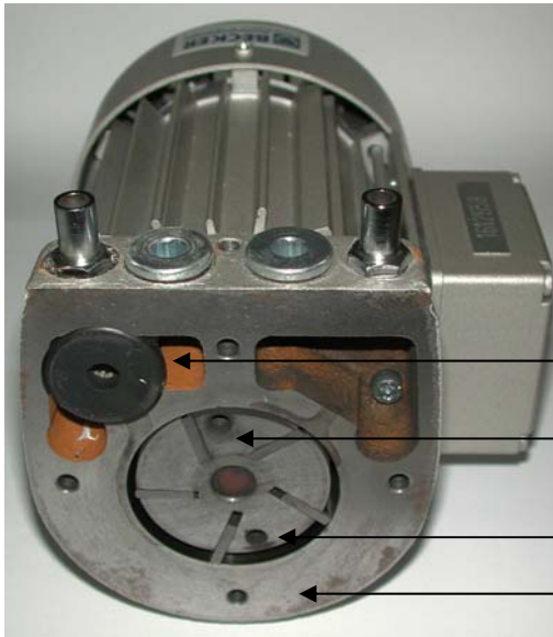
Pumpenvorfilter Drehschieber Rotor Gehäuse
